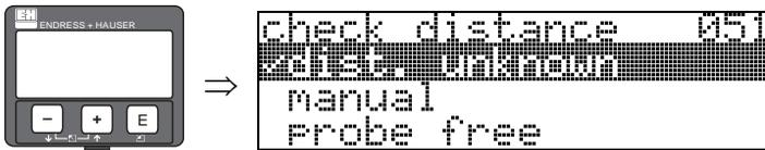
Эта функция инициирует отображение паразитных эхо-сигналов. Для этого измеренное расстояние сравнивается с фактическим расстоянием до поверхности продукта. Предусмотрены следующие опции:
