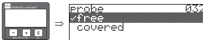
Эта функция используется для определения того, покрыт или не покрыт зонд продуктом на момент ввода в эксплуатацию. Если зонд не покрыт, то длина зонда может быть определена автоматически с помощью функции **determine length (Определение длины) (034)**. Если зонд покрыт, то длину зонда необходимо указать в функции **probe length (Длина зонда) (033)**.
