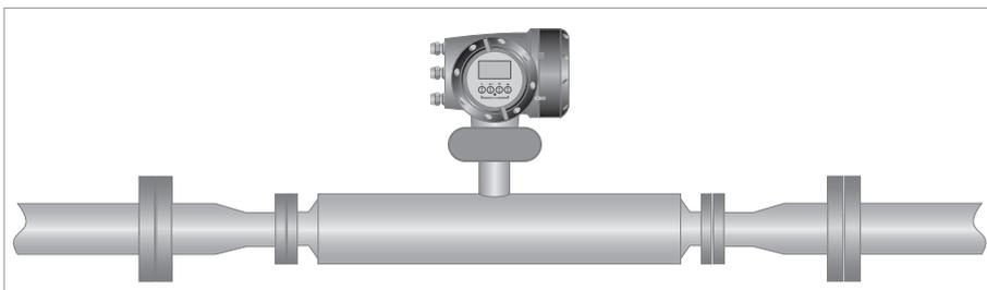
Всегда старайтесь избегать резких ступенчатых изменений типоразмера трубопровода. Используйте переходники типа конфузор и диффузор в тех случаях, когда существует большая разница между диаметром трубопровода и фланцами прибора.
