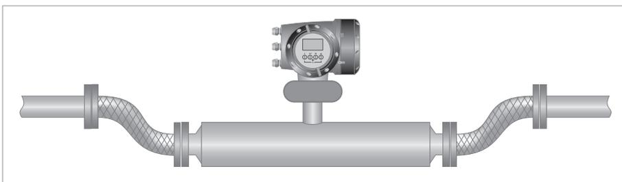
Допускается применение гибких присоединений, но при высоких расходах, обычно связанных с приборами больших диаметров, рекомендуется не прибегать к гибким присоединениям на приборах с типоразмером свыше 80.
