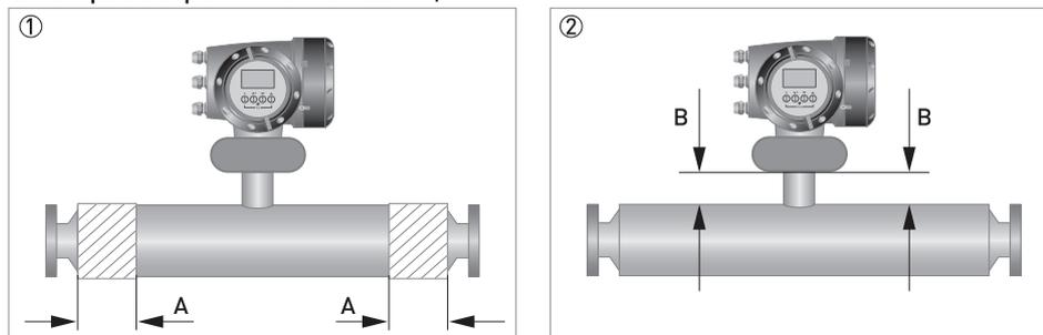
① Допускается обогрев следующей области (А). Максимальные размеры приведены в таблице.
