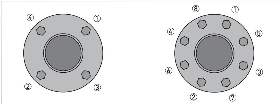
Используйте одинаковые усилия для равномерной затяжки болтов.
