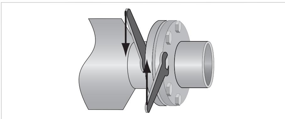
Поочередно затяните болты фланцев с равномерным усилием.
