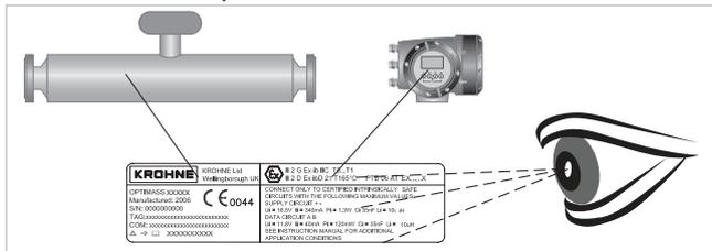
Чтобы гарантировать соответствие измерительного прибора директиве по оборудованию, работающему под давлением, Вы ДОЛЖНЫ удостовериться, что серийные номера на типовой табличке конвертера и первичного преобразователя совпадают.
