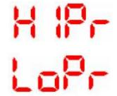
Находясь в пункте меню **HiPr** (**LoPr**) нажмите одновременно две кнопки. На экране дисплея отобразится максимальное (минимальное) давление, измеренное датчиком за время работы. Это значение не сохраняется при отключении питания, его также можно удалить, нажав одновременно две кнопки и удерживая их в нажатом состоянии более одной секунды.
