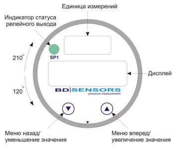
Рисунок 5. Расположение органов управления и отображения
