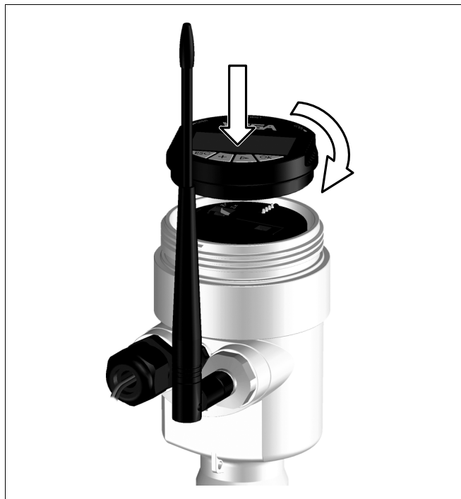
Рис. 12: Установка модуля индикации и настройки
