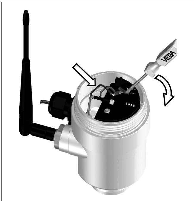
Рис. 9: Шаги 6 и 7 (подключение к источнику питания)
