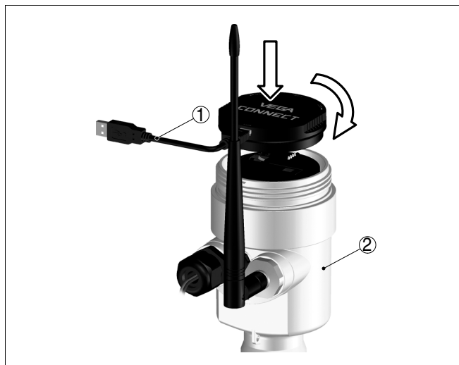
Рис. 14: Установка и подключение к устройству plics ®
