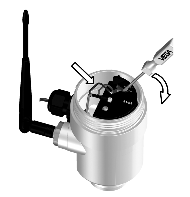
Рис. 8: Шаги 6 и 7 (подключение к источнику питания)
