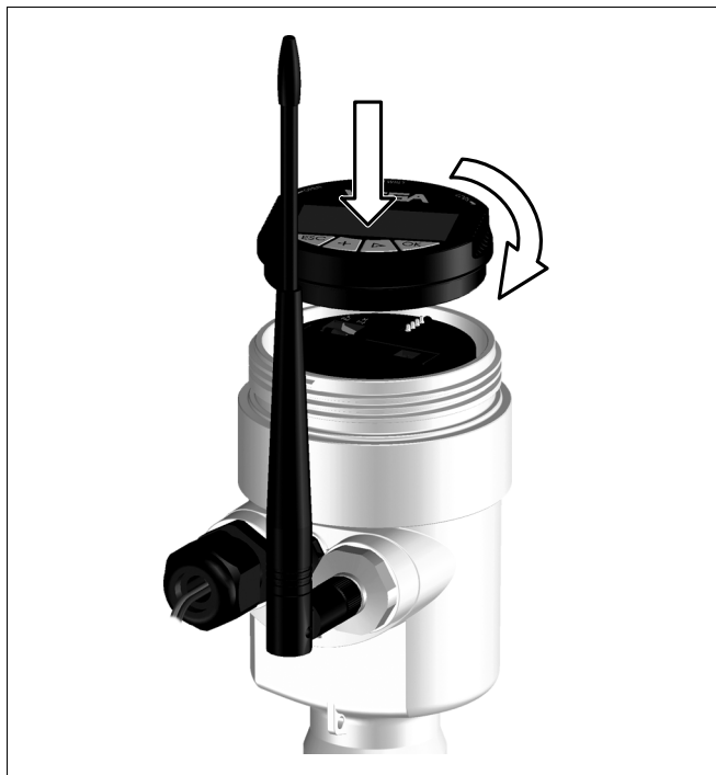
Рис. 12: Установка модуля индикации и настройки
