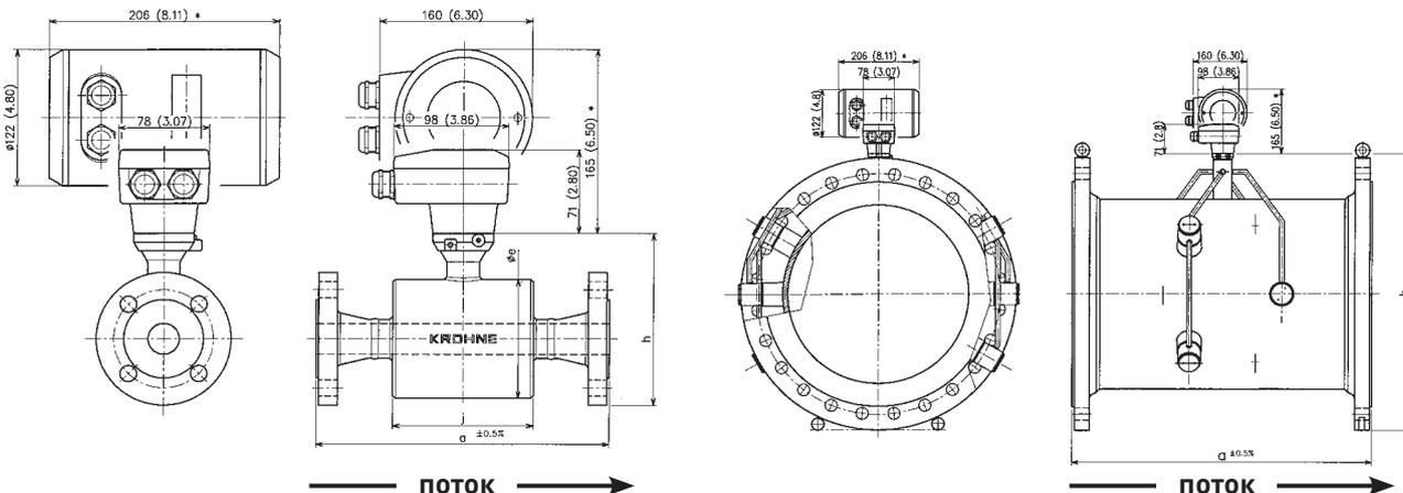
Для взрывозащищенного исполнения добавьте 30 мм в длину и 8 мм в высоту
