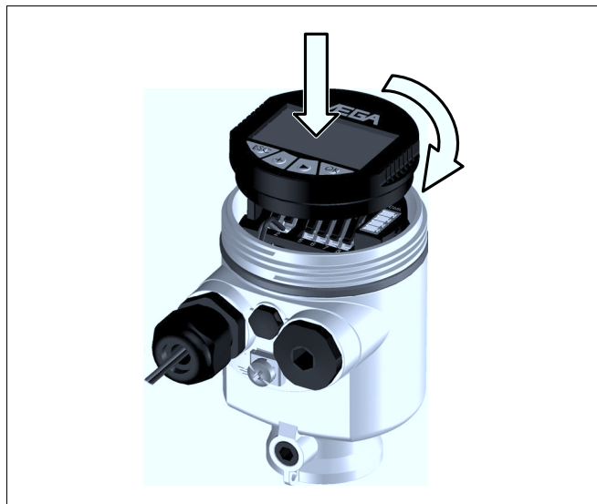
Рис. 19: Установка модуля индикации и настройки
