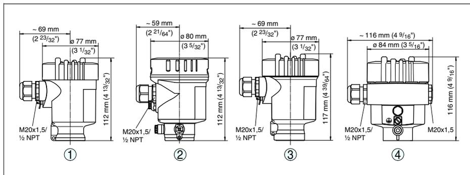
Рис. 16: Корпус в исполнении IP 66/IP 67 и IP 66/IP 68; 0,2 bar (с установленным модулем индикации и настройки корпус выше на 9 мм)
