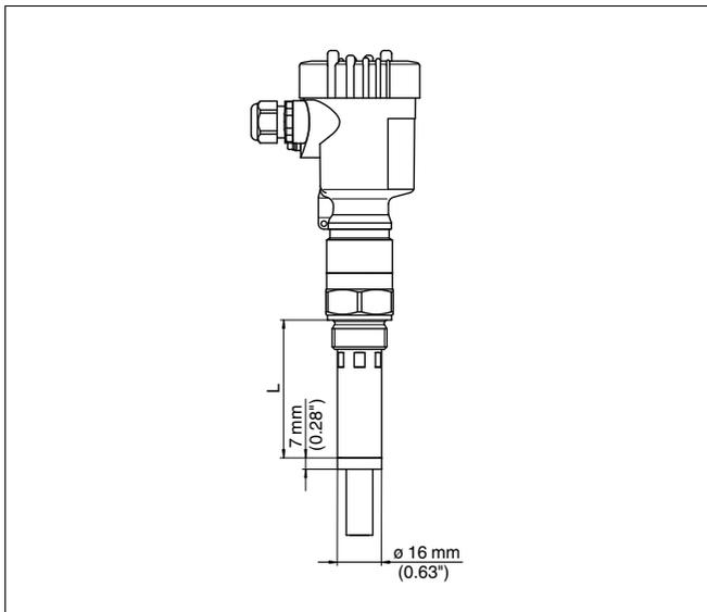
Рис. 21: VEGACAL 65 с экранирующей трубой (например, для защиты от конденсата)
