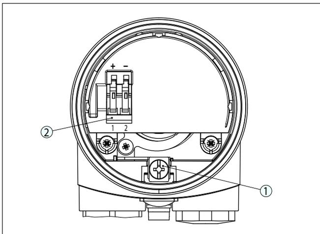
Рис. 8: Отсек электроники и подключения в однокамерном корпусе
