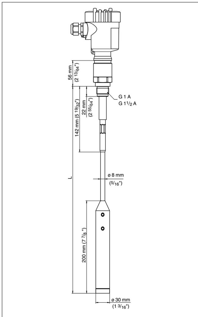
Рис. 19: VEGACAL 65 - тросовое исполнение  $\varnothing 8$  мм, резьба G1 A (ISO 228 T1)
