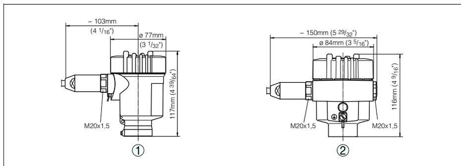
Рис. 17: Корпуса в климатическом исполнении IP 66/IP 68, 1 bar (с установленным модулем PLICSCOM корпус выше на 9 мм)
