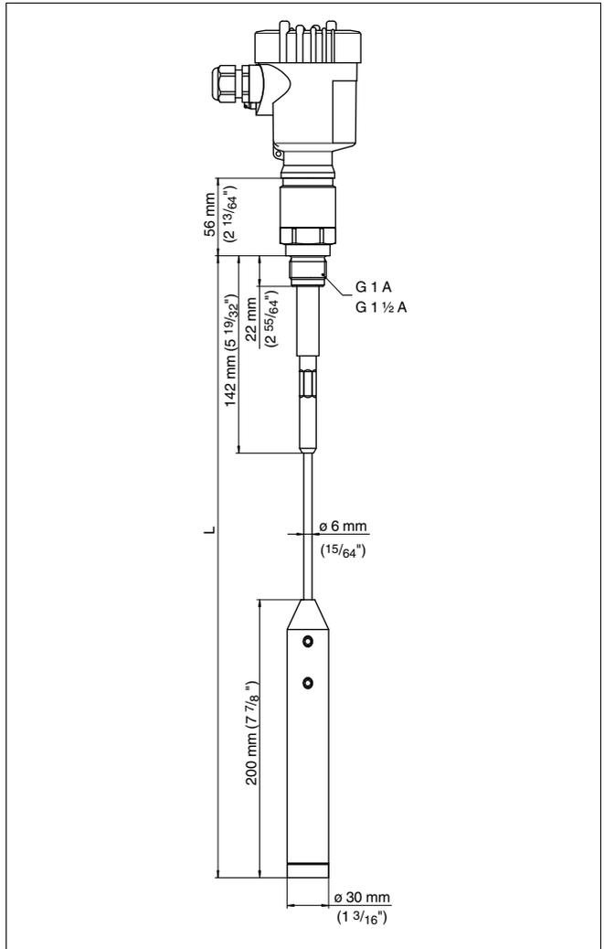
Рис. 18: VEGACAL 65 - тросовое исполнение ø 6 мм, резьба G1 A (ISO 228 T1)
