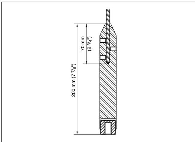
Рис. 13: При укорачивании троса следует учитывать наличие натяжного груза.
