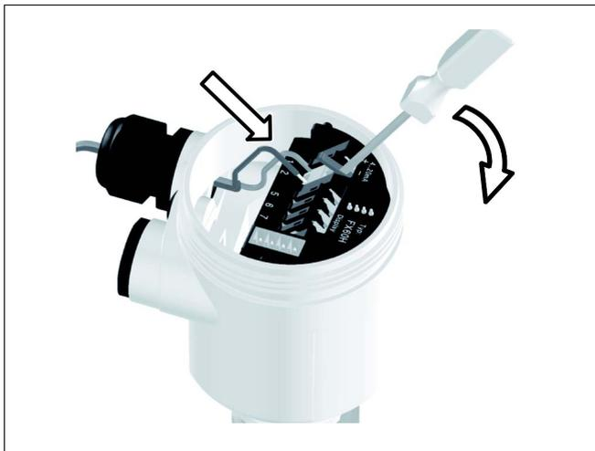
Рис. 5: Подключение к источнику питания: шаги 6 и 7
