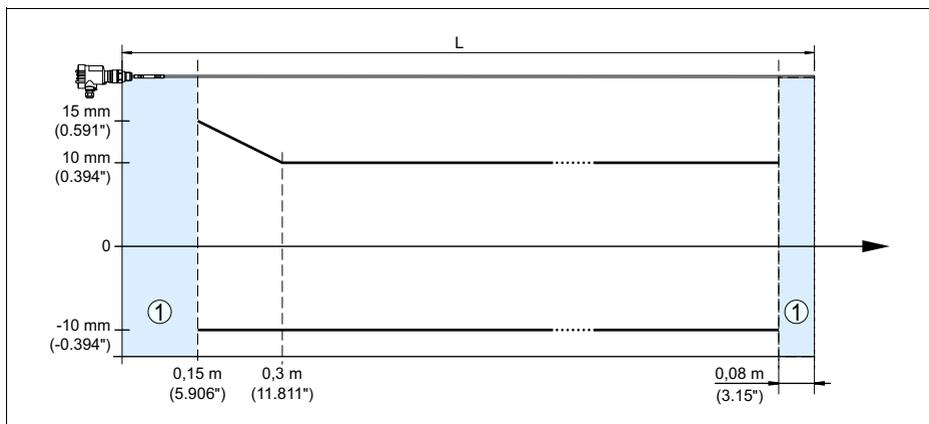
Рис. 21: Погрешность измерения VEGAFLEX 67 в стержневом исполнении
