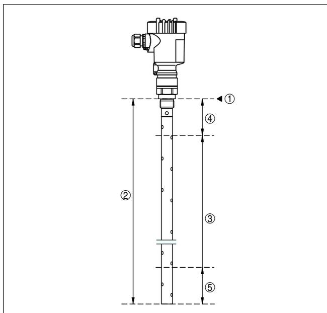
Рис. 17: Диапазон измерения VEGAFLEX 67 - коаксиальное исполнение
