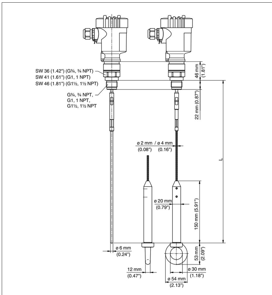
Рис. 34: VEGAFLEX 67, тросовое или стержневое исполнение, с резьбовым присоединением
