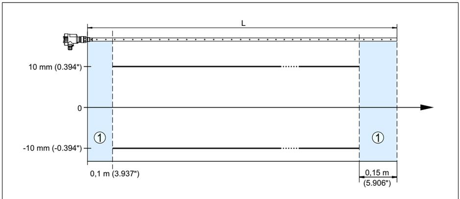
Рис. 23: Погрешность измерения VEGAFLEX 67 в коаксиальном исполнении
