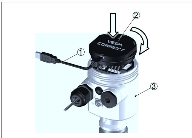
Рис. 15: Подключение ПК через VEGACONNECT прямо на датчике
