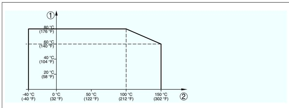
Рис. 24: Температура окружающей среды - Температура процесса
