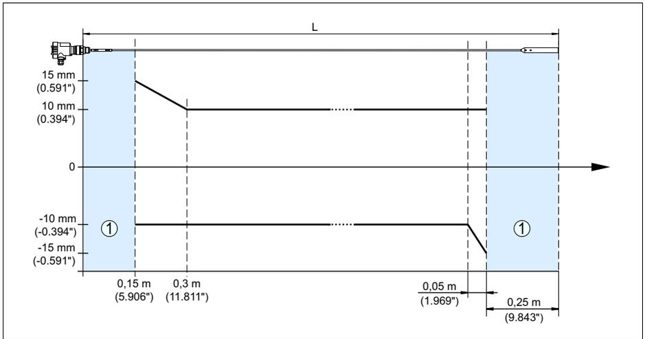
Рис. 22: Погрешность измерения VEGAFLEX 67 в тросовом исполнении
