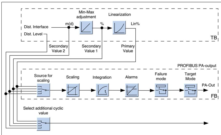
Рис. 25: VEGAFLEX 67: Блок-схема со значением AI (PA-OUT) и дополнительным циклическим значением
