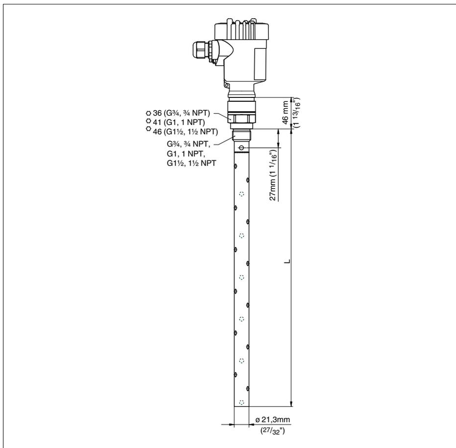
Рис. 35: VEGAFLEX 67, коаксиальном исполнении с резьбовым присоединением
