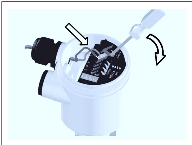
Рис. 6: Подключение к источнику питания: шаги 6 и 7
