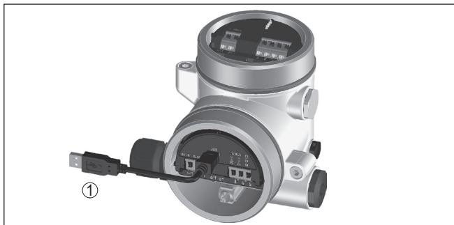
Рис. 33: Подключение ПК через USB к электронике Modbus
