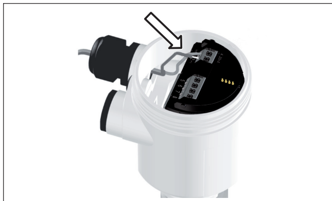
Рис. 4: Подключение: шаги 5 и 6
