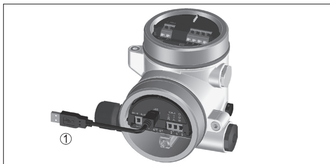
Рис. 24: Подключение ПК через USB к электронике Modbus
