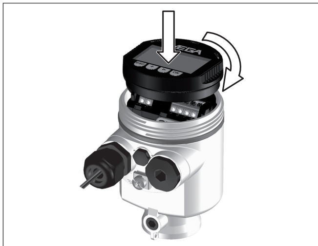
Рис. 17: Установка модуля индикации и настройки в однокамерном корпусе
