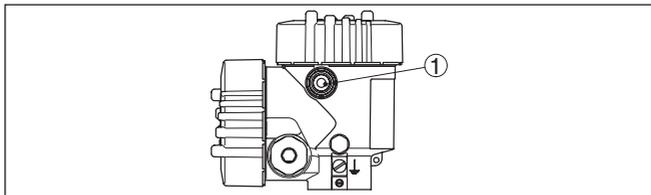
Рис. 20: Кнопка включения/выключения снаружи на корпусе
