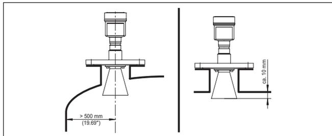
Рис. 1: Расстояние от антенны до стенки емкости/крыши емкости
