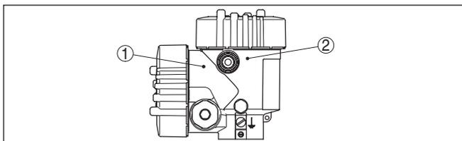
Рис. 17: Положение отсека питания и электроники
