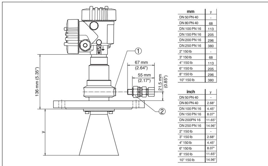
Рис. 45: VEGAPULS 66, стандартное исполнение со входом для подключения продувки
