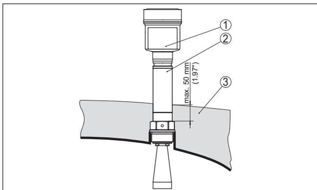
Рис. 16: Монтаж устройства на емкости с термоизоляцией
