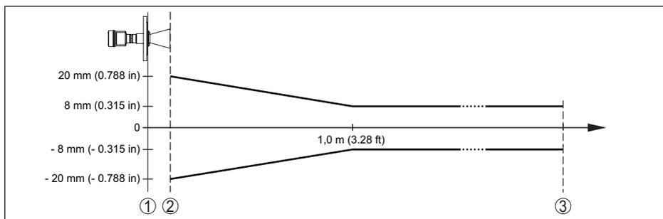
Рис. 42: Погрешность измерения при эталонных условиях
