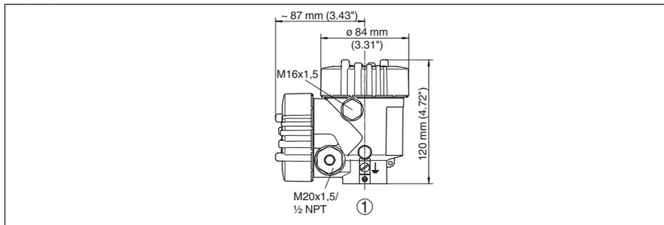
Рис. 43: Размеры корпуса - с установленным модулем индикации и настройки корпус выше на 9 мм (0.35 in)
