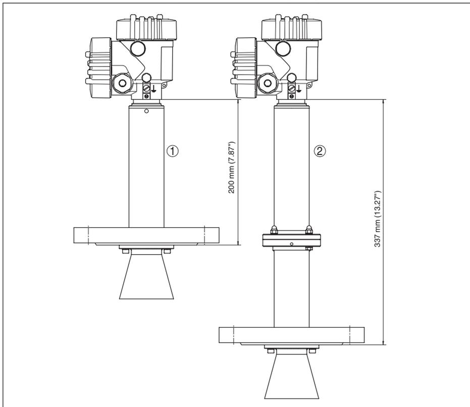
Рис. 46: VEGAPULS 66, исполнение для высоких температур
