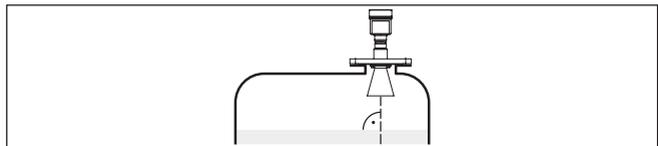
Рис. 11: Ориентация датчика на жидкостях
