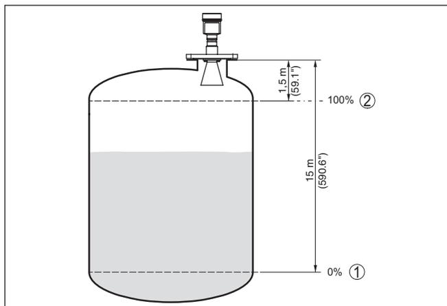
Рис. 23: Пример выполнения Установки Min./Max.
