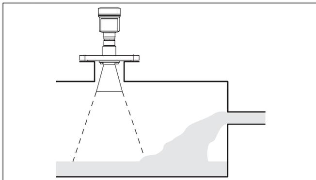
Рис. 8: Монтаж радарного датчика при втекающем продукте
