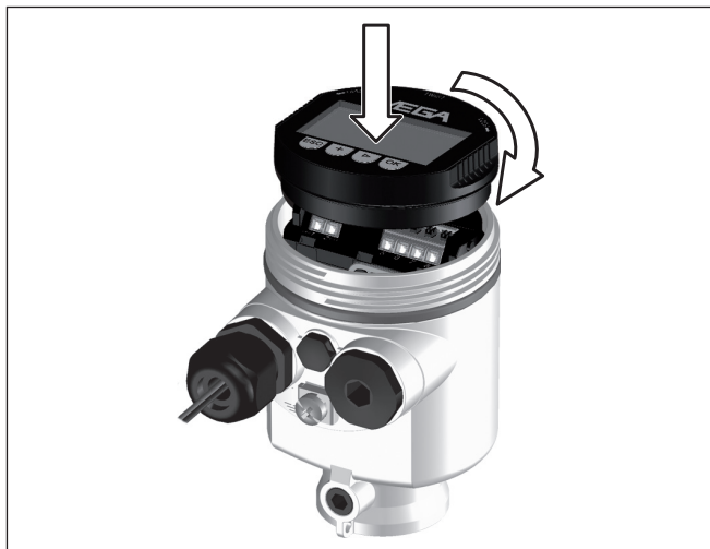
Рис. 36: Установка модуля индикации и настройки в отсеке электроники однокамерного корпуса
