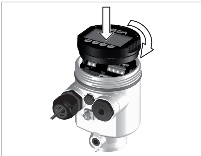
Рис. 32: Установка модуля индикации и настройки в отсеке электроники однокамерного корпуса
