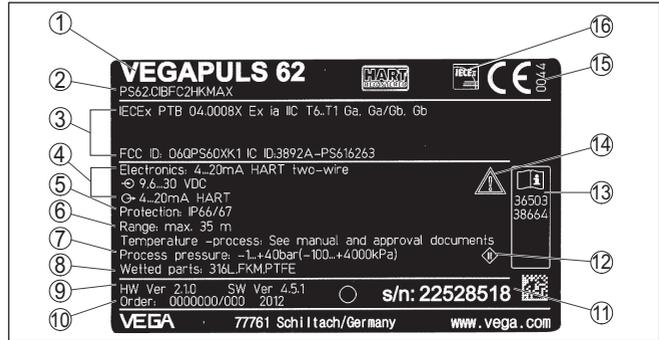
Рис. 4: Данные на типовом шильдике (пример)
