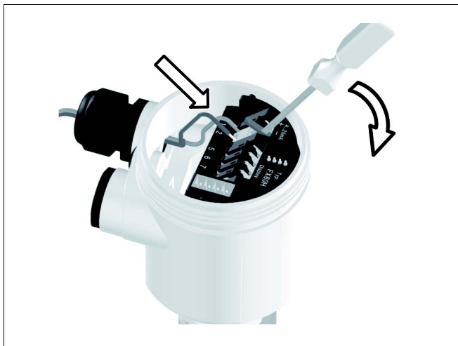
Рис. 15: Подключение к источнику питания: шаги 6 и 7
