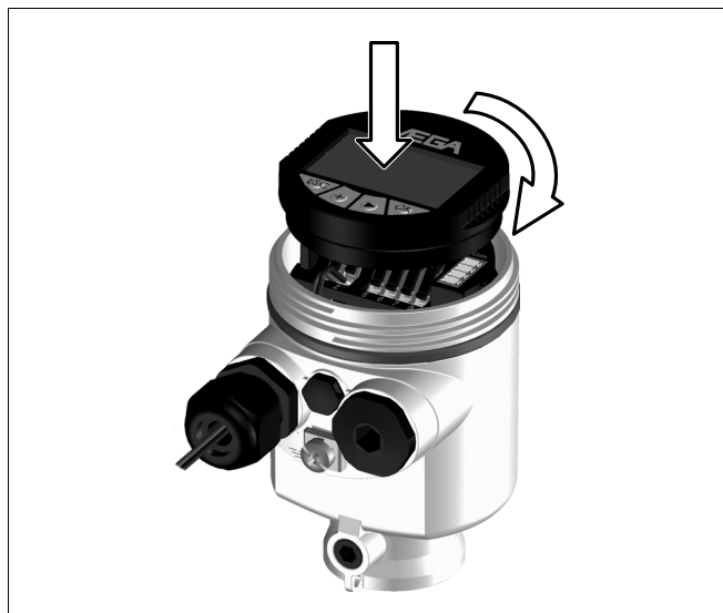
Рис. 24: Установка модуля индикации и настройки
