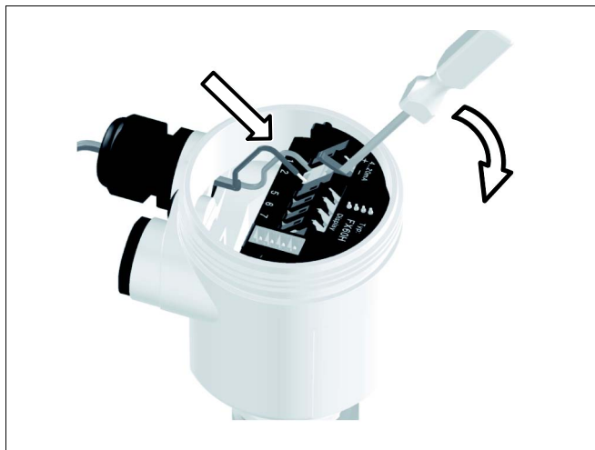
Рис. 15: Подключение к источнику питания: шаги 6 и 7
