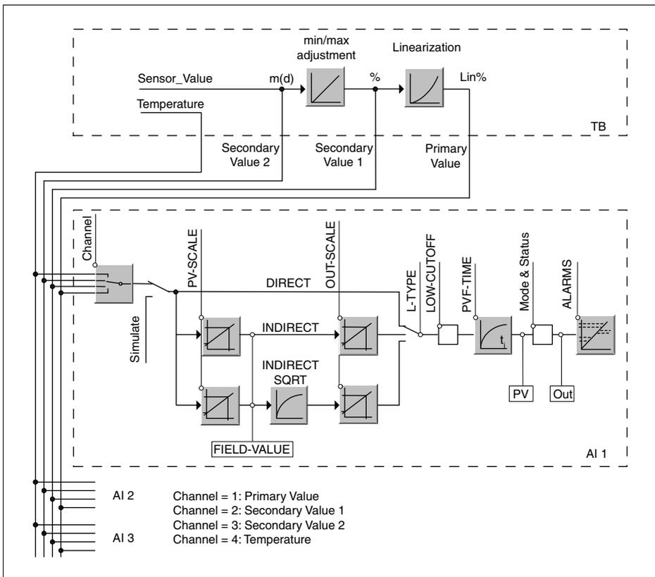
Рис. 29: Обработка измеренных значений VEGASON 62
