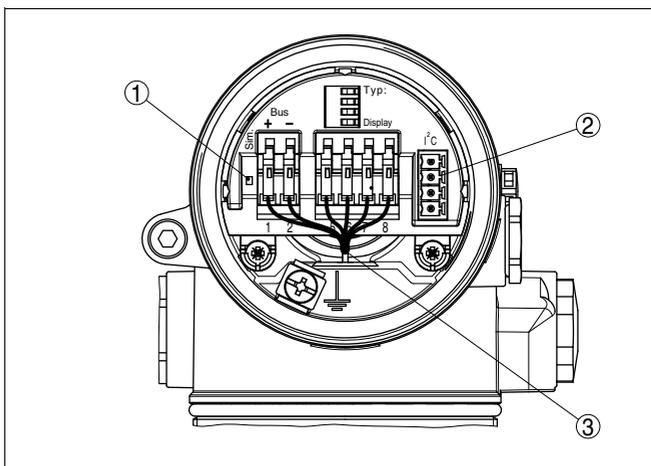
Рис. 20: Отсек электроники в двухкамерном корпусе
