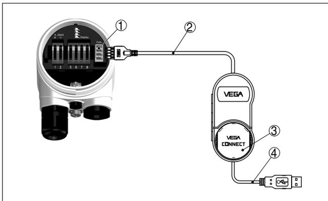
Рис. 27: Подключение через соединительный кабель I<sup>2</sup>C
