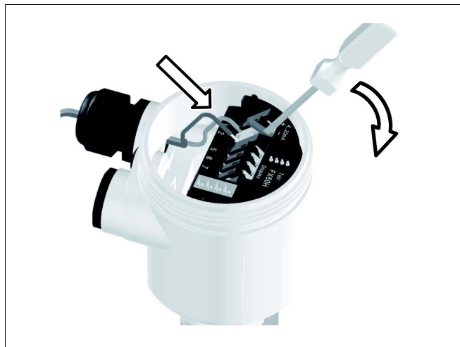
Рис. 15: Подключение к источнику питания: шаги 6 и 7
