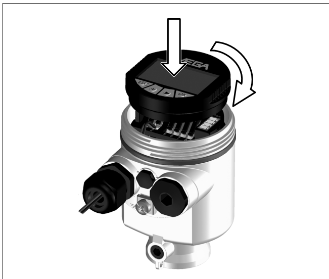
Рис. 23: Установка модуля индикации и настройки
