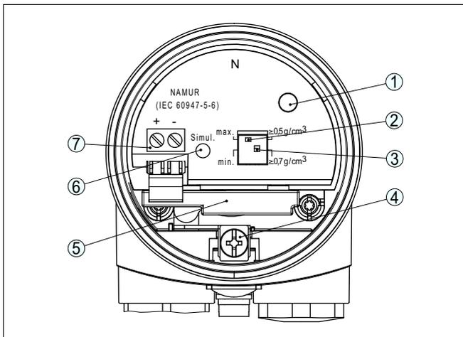
Рис. 9: Отсек электроники и подключения - однокамерный корпус
