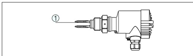
Рис. 3: Горизонтальный монтаж
