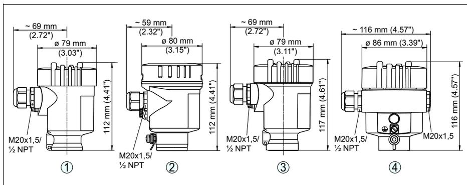
Рис. 28: Исполнения корпуса со степенью защиты IP 66/IP 67 и IP 66/IP 68; 0,2 bar
