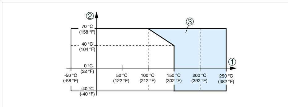
Рис. 25: Температура окружающей среды - Температура процесса
