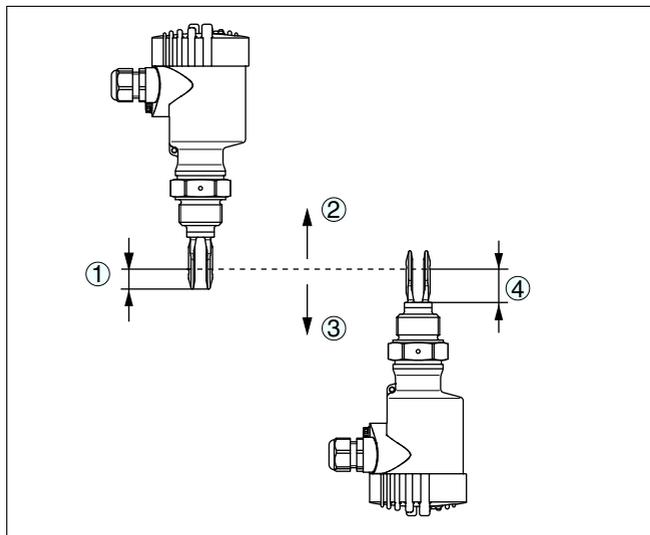
Рис. 2: Вертикальный монтаж
