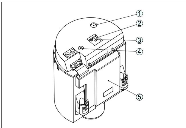
Рис. 12: Блок электроники SWE60N - выход NAMUR
