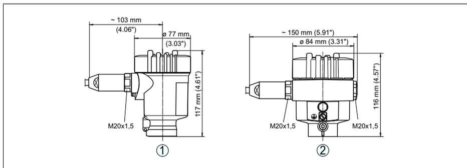
Рис. 29: Исполнения корпуса со степенью защиты IP 66/IP 68 (1 bar)
