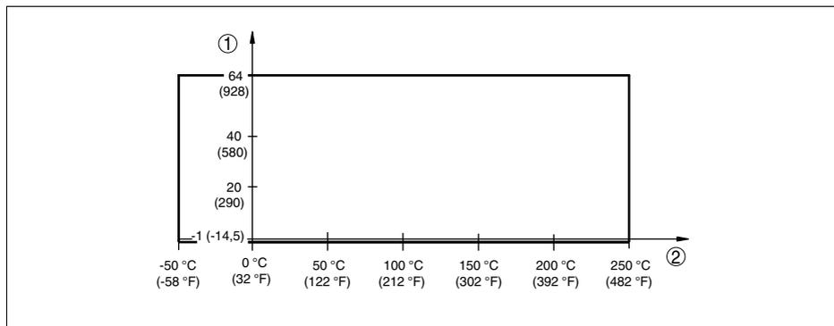
Рис. 26: Температура процесса - давление процесса при установке переключателя 0,7 г/см<sup>3</sup> (переключатель чувствительности)
