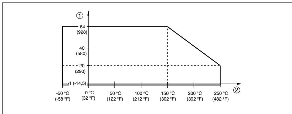
Рис. 27: Температура процесса - давление процесса при установке переключателя 0,5 г/см<sup>3</sup> (переключатель чувствительности)
