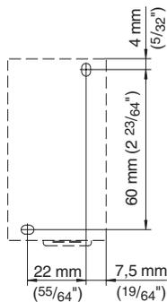
Рис. 2: Схема отверстий VEGATOR 256C
