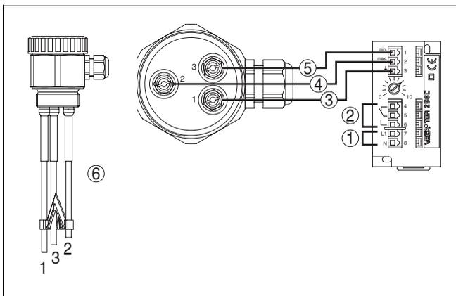
Рис. 4: Управление насосом
