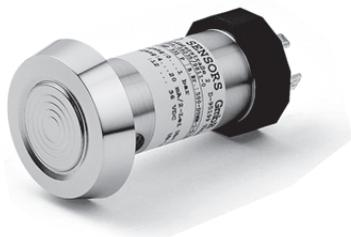
DMK 331P – это преобразователь давления для измерения давления в технологических процессах. Благодаря торцевой мембране DMK 331P пригоден для измерения давления вязких сред, химически совместимых с нержавеющей сталью 1.4435 (316L) и материалом уплотнения.
