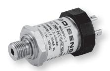
Датчик давления DMP 343 предназначен для измерения низкого давления от 10 мбар (1 кПа), а также для вакуумных измерений -1...0 бар (-100...0 кПа).
