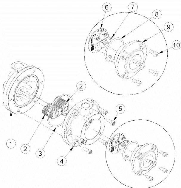
При переустановке роторов все магниты должны быть направлены к панели импульсного выхода, магниты скрыты внутри роторов из нержавеющей стали, однако их можно обнаружить, используя другой магнит или железный предмет; алюминиевые роторы оснащены видимыми магнитами в их верхней части.
