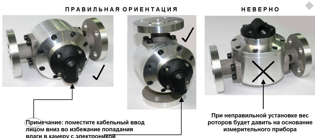
Жидкость может попадать в счетчик как из горизонтального, так и из вертикального положения. Для вертикального монтажа наиболее распространена ориентация для жидкости, поднимающейся через счетчик (например, снизу вверх), для содействия воздуху или выведения
