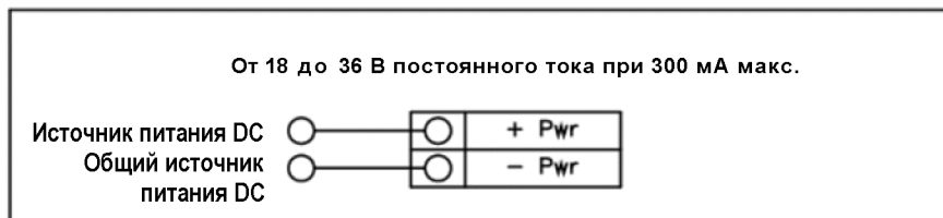
Рисунок 2-25. Подключение к источнику питания постоянного тока
