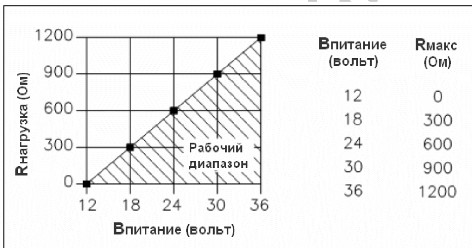
Рисунок 2-26. Зависимость сопротивления нагрузки от входного напряжения
