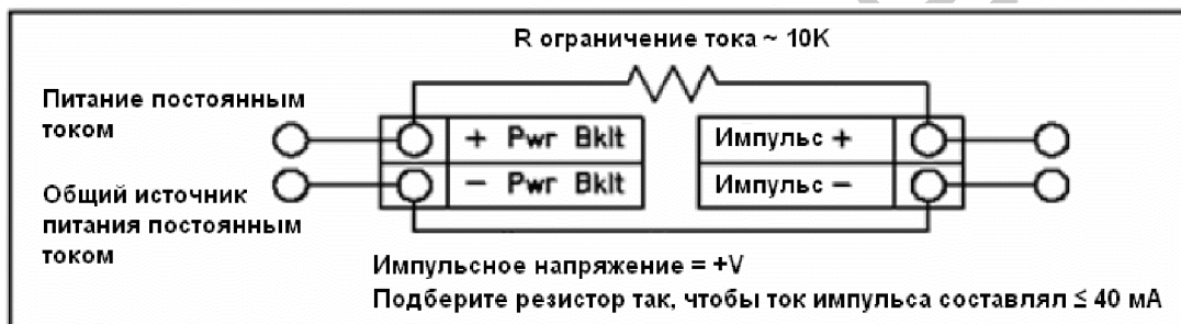
Рисунок 2-18. Подключение неизолированного импульсного выхода посредством внешнего источника питания
