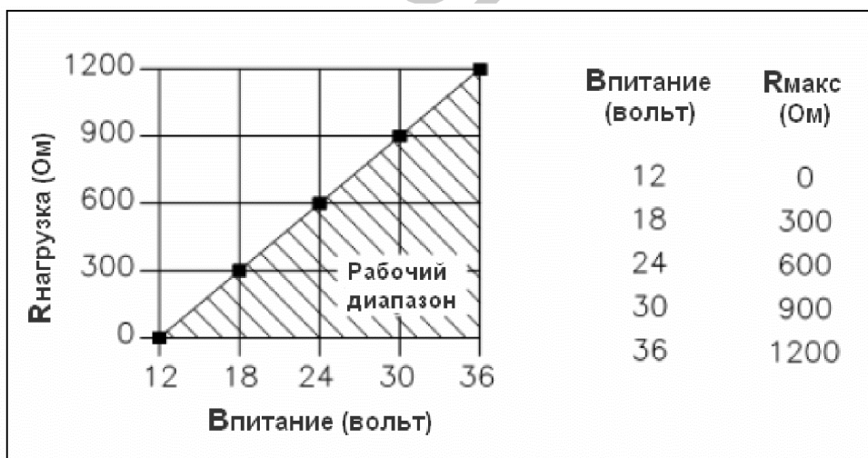
Рисунок 2-16. Зависимость сопротивления нагрузки от входного напряжения
