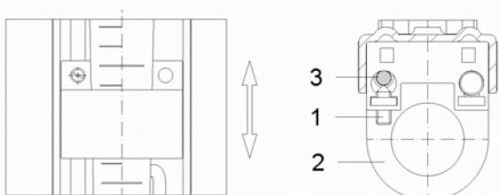
Пороговый переключатель (кольцеобразный) может регулироваться наряду с мензуркой. Он зафиксирован винтом (1) на направляющем штоке (3).
