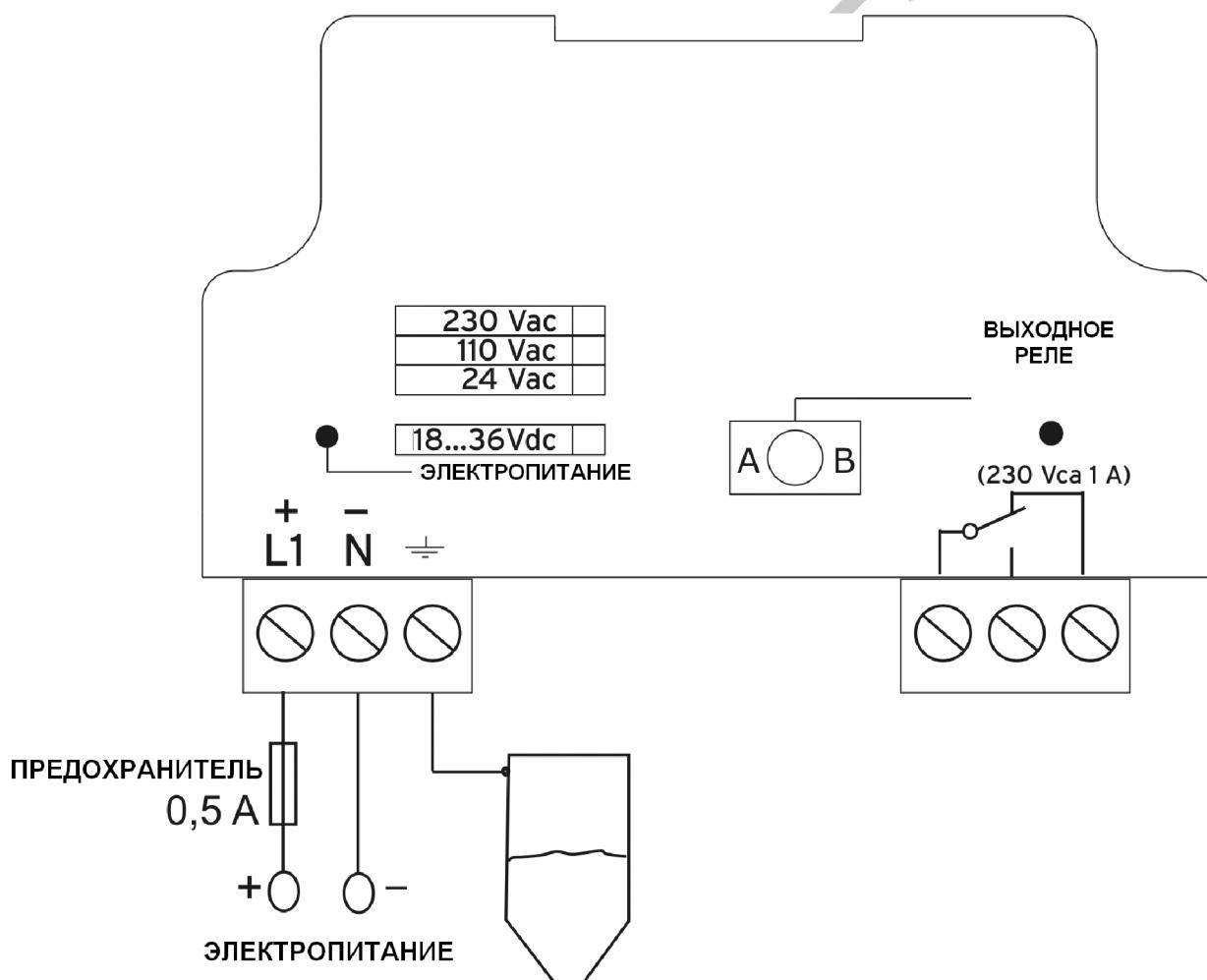
Подача напряжения к датчику уровня NSV осуществляется при помощи клемм L1 (+) и N(-). В питающий токовый ввод устанавливаются соответствующие **плавкие предохранители**. Зеленый светодиод указывает на то, что электропитание подается к прибору. До подключения изделия **проверьте** соответствие значений питающего напряжения номинальным значениям, указанным для датчика уровня NSV.
