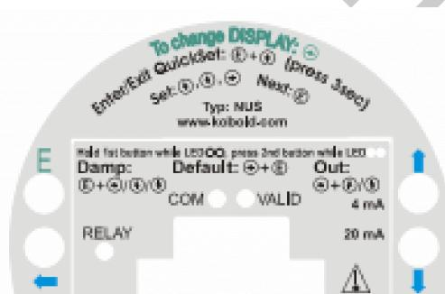
**Примечание:** выходные аналоговые данные могут быть запрограммированы в инвертированном (обратном) порядке: 4 mA=100% (полное заполнение, 20 mA= 0% (пустой)).
