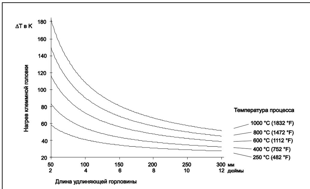
Нагрев клеммной головки, обусловленный рабочей температурой
