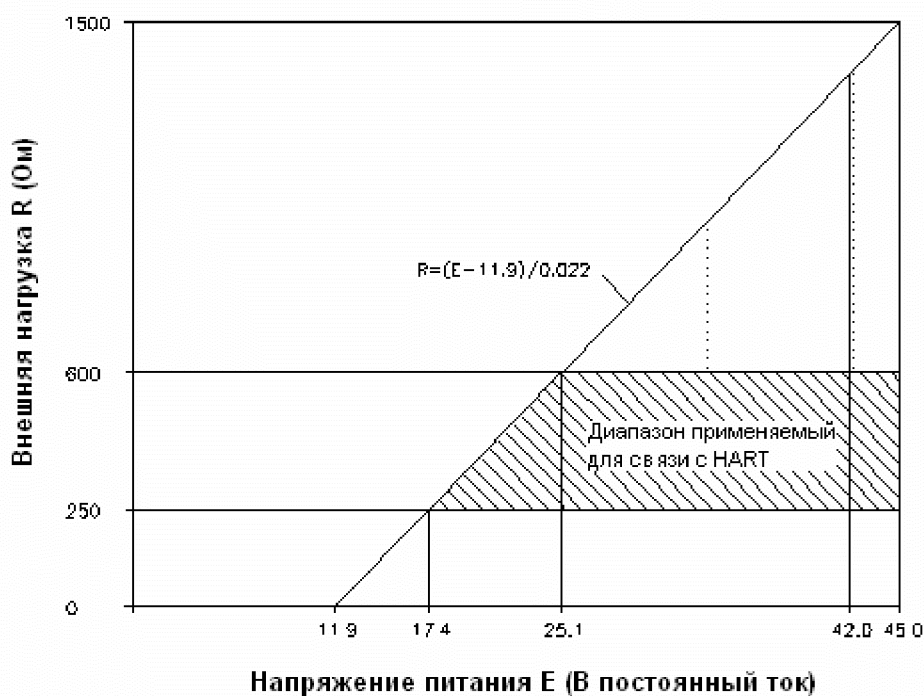
Изображение 6-5. Электропитание интеллектуального датчика давления модели PAS
