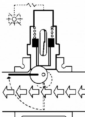
При перемещении в трубопроводе жидкость перемещает лопасть, которая вращает эксцентрик, который в свою очередь поднимает узел, находящийся в приборе. Узел содержит в себе встроенный постоянный магнит. Это позволяет магниту активировать герметично изолированный герконовый переключатель. Сигнал от герконового переключателя может быть использован в качестве инициатора аварийной сигнализации или индикатора. При использовании соответствующего реле, можно автоматически контролировать насосы,
